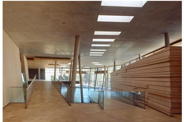
Das ein- bis zweigeschossige Gebäude mit den maximalen Abmessungen von 108 x 63 m im Grundriss ist in Stahlbetonbauweise erstellt. Die weitgespannte und unregelmäßig punktgestützte Dachplatte, geneigte schlanke Stahlverbundstützen bis zu 7,50 m Länge, geneigte Sichtbetonwände und weit auskragende Dachränder sind charakteristisch für die Gebäudeform und die Konstruktion.
